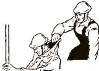
Նկ.3. Մինչև 1000 Վ էլեկտրատեղակայանքներում էլեկտրական հոսանքի ազդեցությունից տուժածին ազատելը՝ չոր հագուստից քաշելով
