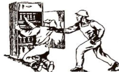
Նկ.4. Մինչև 1000 Վ լարման տակ գտնվող հոսանատար մասից տուժածին զատելը
